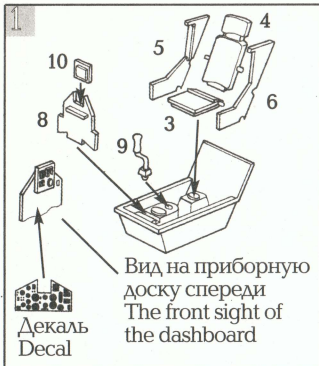
Сборка / Assembly Put into the bow a weight no less than 5 g. Add weight 5 g В носовую часть поместить груз весом не менее 5 грамм
