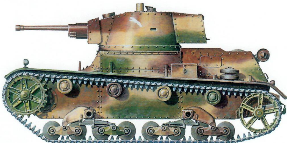
7TP light tank. The carriage in the standard camouflage scheme for the single-turret 7TP, introduced in early 1936. 7TP tanks in this camouflage scheme (with no badges or markings) took part in fighting in September 1939. Lekki czołg 7TP. Pojazd w podstawowym dla 7TP schemacie maskowania wprowadzonym na początku 1936 roku. W takim rodzaju malowania (bez godel i oznaczeń) czołgi 7TP wzięły udział w kampanii wrześniowej 1939 roku.
