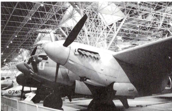
●カナダ国立航空博物館所蔵、モスキートB20 (B20はBMkIVカナダ生産型です)
